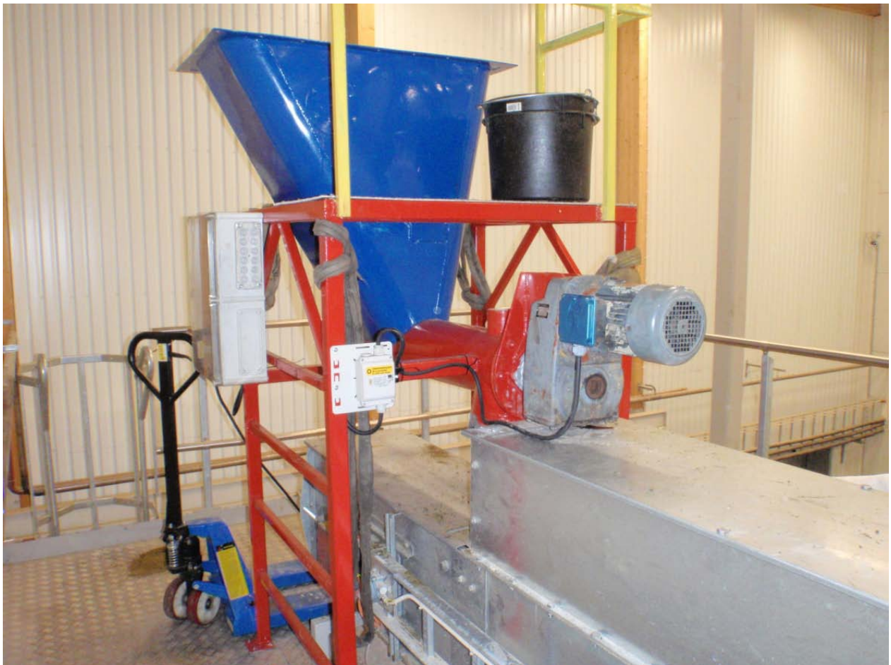
Figur 1. Frekvensstyrd inmatningsskruv med tratt för påfyllning.
